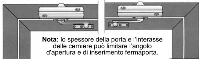
Montaggio rovesciato lato opposto cerniere Reversed mounting push side
